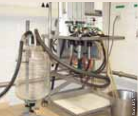
Een laboratoriumopstelling om de verhouding tussen lucht en melk te kunnen variëren.
